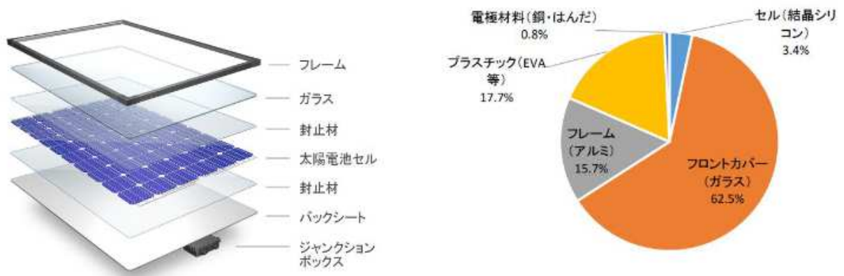
図 5-12 太陽電池モジュールの構造と重量比
